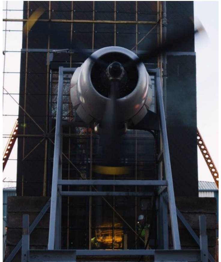
Dynamische windtest - UL Solutions, Telford (UK)
